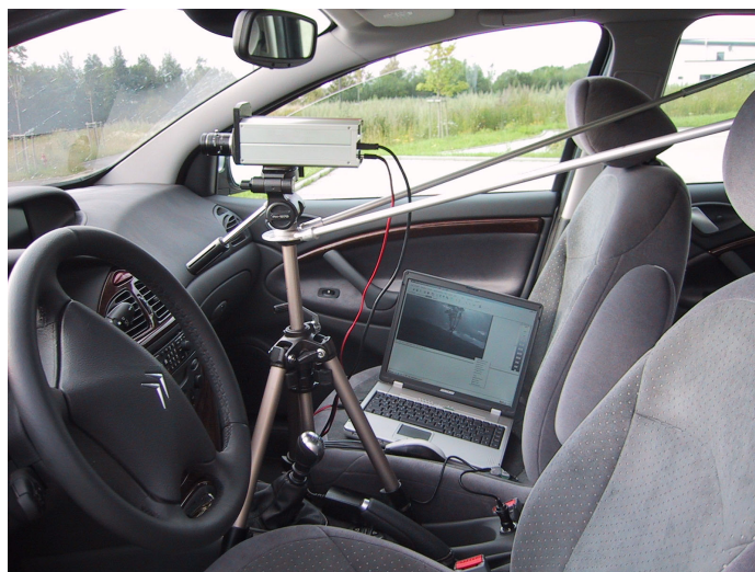
Bild 1: Aufbau der Kamera in einem Fahrzeug für die Erfassung von Leuchtdichtebildern während der Fahrt
